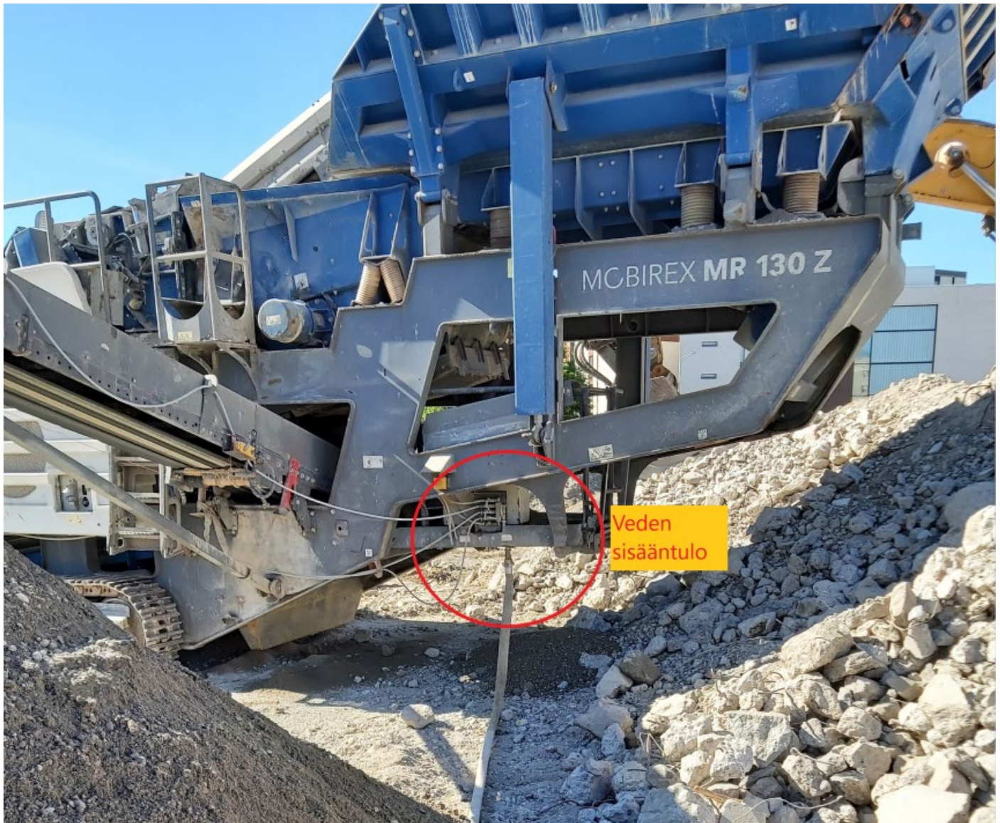
Kuva 3. Veden syöttö murskaimeen (Kleeman).
